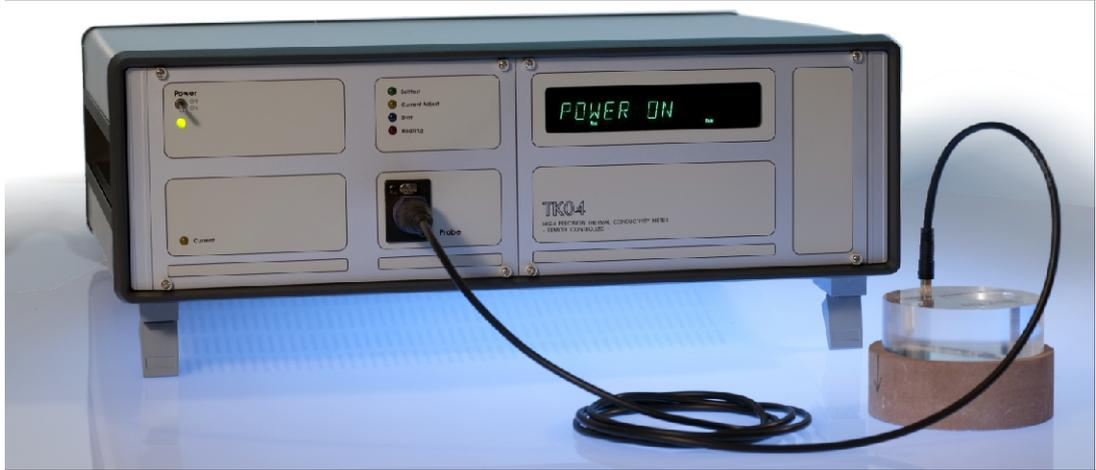
TK04 ist zur schnellen und genauen Bestimmung der Wärmeleitfähigkeit geeignet, wenn stationäre Messungen zu aufwendig und herkömmliche instationäre Verfahren zu ungenau sind.
