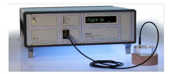
El TK04 está diseñado para la rápida y precisa realización de pruebas de conductividad térmica donde los métodos de estado estacionario llevan demasiado tiempo y donde los métodos convencionales transitorios no cumplen con los requerimientos de exactitud.
